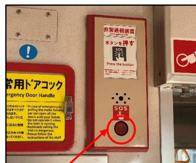
非常通報ボタン
