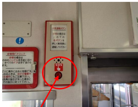
非常通報ボタン
