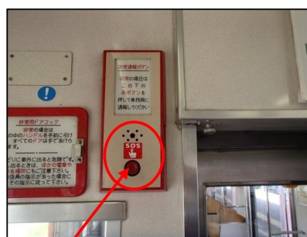
非常通報ボタン
